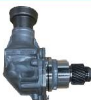
前後輪へ動力を分配する駆動系パーツ
