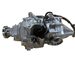
前輪と後輪に油圧ポンプを配置
